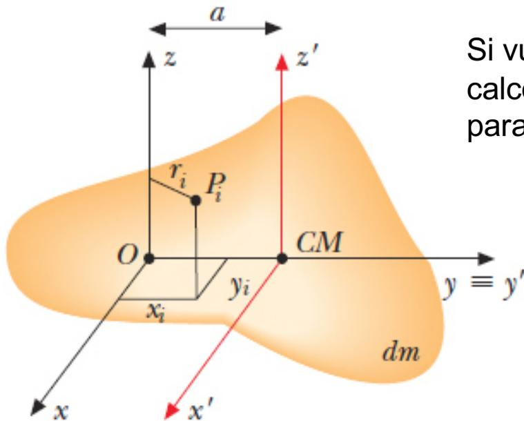
Si vuole trovare la relazione fra i momenti di inerzia di un corpo rigido calcolati rispetto ad un asse  $z'$  passante per il CM e ad un altro asse  $z$  parallelo al precedente e passante per un punto  $O$  distante  $d$  dal CM
